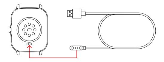
**Nota:** No tenga el cable del cargador conectado a corriente y los imanes contactando una superficie metálica. Provocará calentamiento y daños en el cargador.
